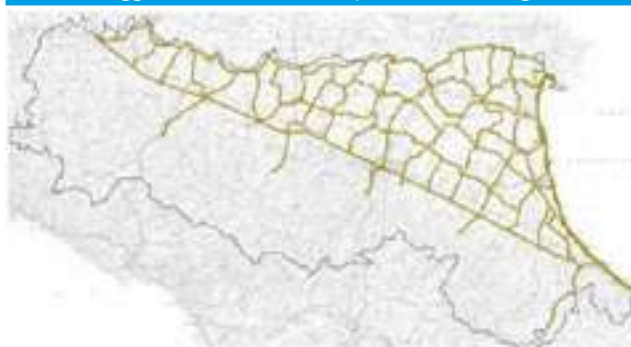
FIGURA 16 Mappa delle linee di livellazione della rete per il monitoraggio della subsidenza Arpae Emilia-Romagna.
