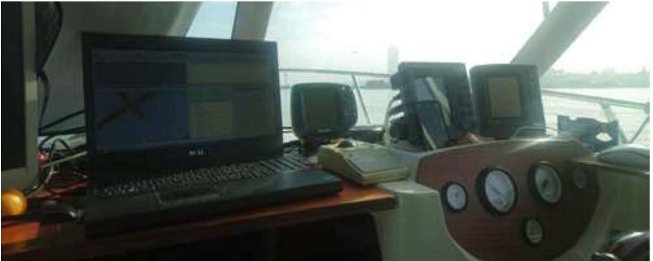
FIGURA 37 Rilievo multibeam 2018: postazione di acquisizione dati.
