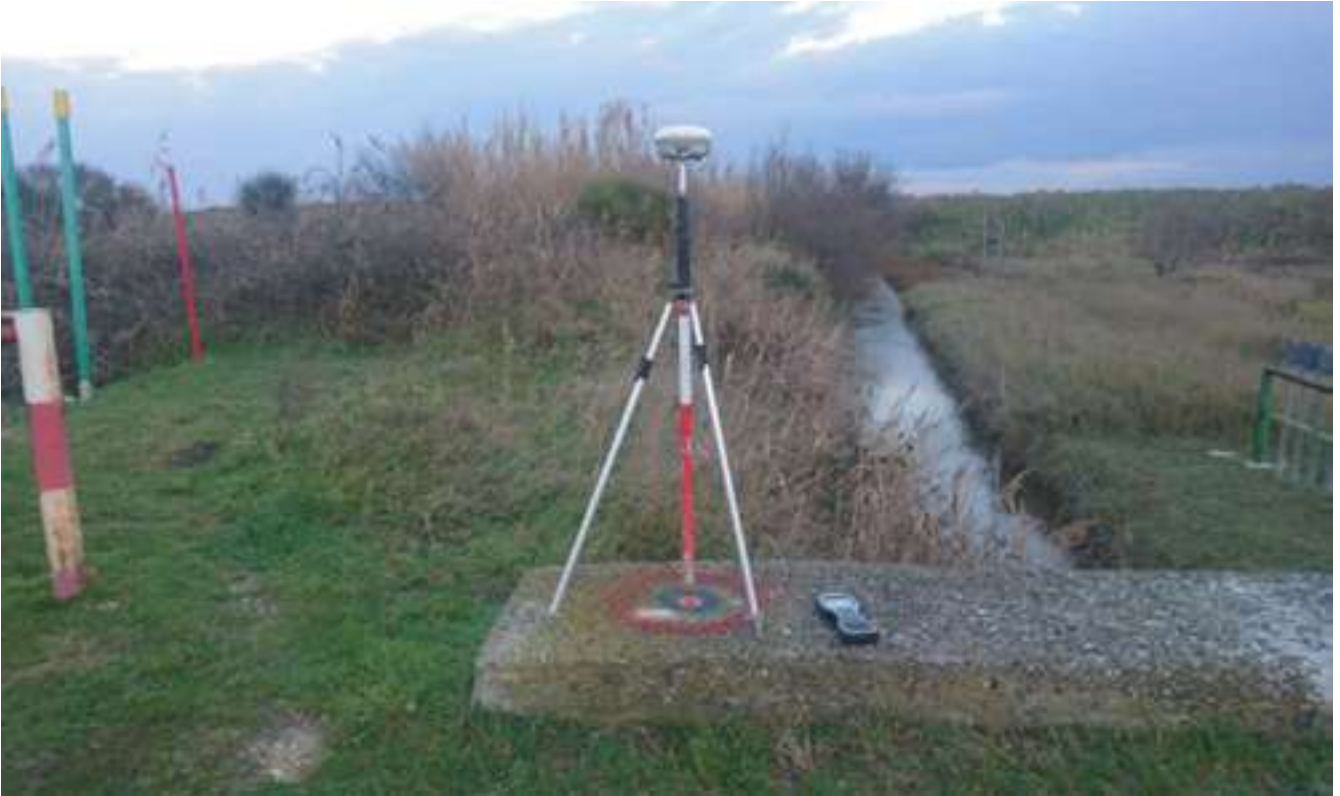
FIGURA 35 Rete Geodetica Costiera: posizionamento della stazione master su un vertice.
