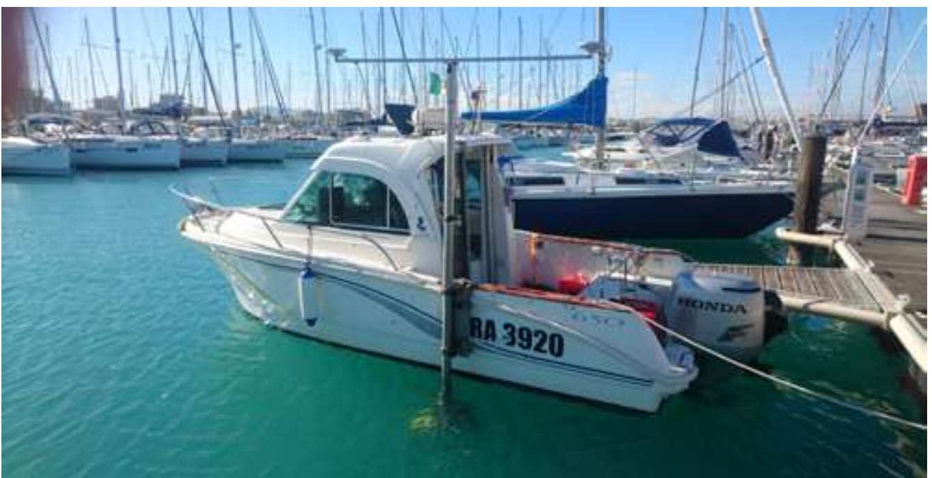
FIGURA 39 Sistema integrato per rilievo multibeam.
